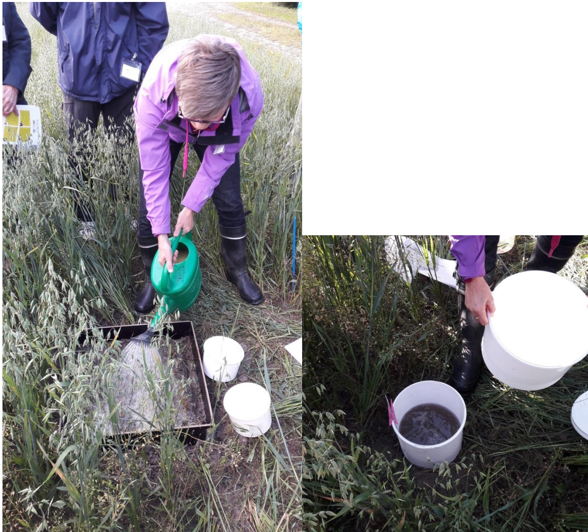
Kuva 3. Peltomaan laatutestiin kuuluvalla sinappivesitestillä kartoitetaan kastelierojen määrää pellossa. Sinappitestiä varten on maahan upotettu kehikko ja pintamaan vedenjohtavuuden määrittäminen tehdään maahan upotetun pohjattoman ämpärin avulla.
