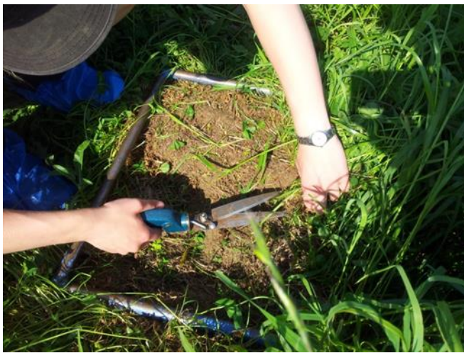
Kuva 2. Massan määrittämistä varten kasvustonäytteet leikataan määräalalta (esim. 0,25 m 2 :n kehikko), näytteiden tuoremassat punnitaan ja muutetaan kuiva-ainesadoksi käyttämällä apuna eri kasvilajien kuiva-ainepitoisuustietoja.
