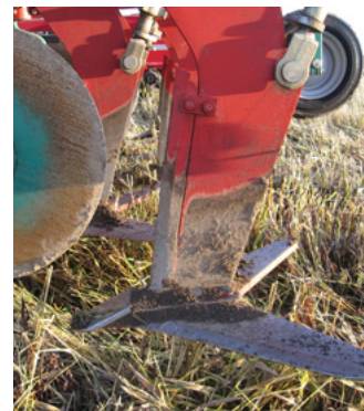
Kuva 3 ja 4. Kvernelandin juuristoleikkuri leikkaa kestorikkakasvien maan- alaisia osia maata kääntämättä. Työsyvyys säädetään ajankohdan ja rikka- kasvilajin perusteella.
