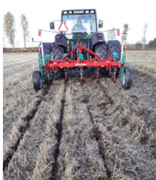
Kuva 3 ja 4. Kvernelandin juuristoleikkuri leikkaa kestorikkakasvien maan- alaisia osia maata kääntämättä. Työsyvyys säädetään ajankohdan ja rikka- kasvilajin perusteella.
