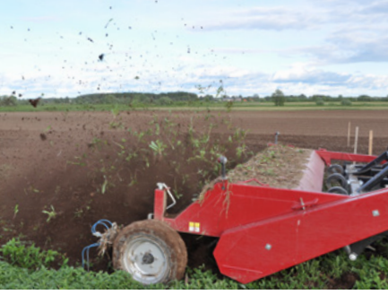
Kuva 4. Osa peltovalvatin juuristosta on Kwick-Finn -muokkaimen hanhenjalkaterien ja roottoripiikkien ulottuvilla. Muokkauksia kannattaa pikakesannossa toistaa valvatin 3-4 -lehtiasteella työsyvyyttä lisäten.
