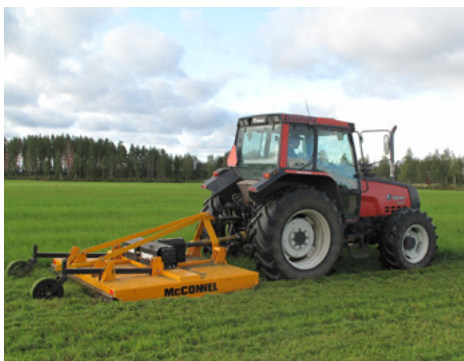
Kuva 2. Nurmen tiheä niitto tehoaa hyvin valvattiin. Tämän tyyppinen kesantomurskain tuottaa imun, jolloin traktorin pyörien alle lakoontuneetkin valvatit katkeavat.
