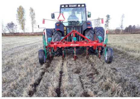
Kuva 5 ja 6. Kvernelandin juuristoleikkuri leikkaa peltovalvatin juuristoa maata kääntämättä. Työsyvyyttä säädetään ajankohdan ja rikkakasvilajin perusteella.
